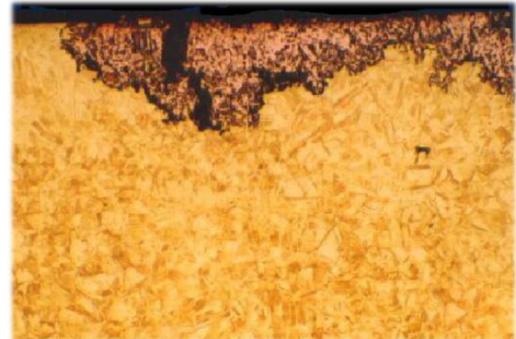
Şekil 16. Pirinç malzemesinde yüzeyden başlayan çinkosuzlaşma
