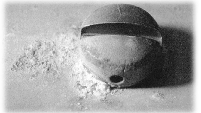
Şekil 2. Galvanik korozyon. Paslanmaz çelik vida, alüminyum esaslı plaka malzemedeki galvanik korozyona neden olmuştur.
